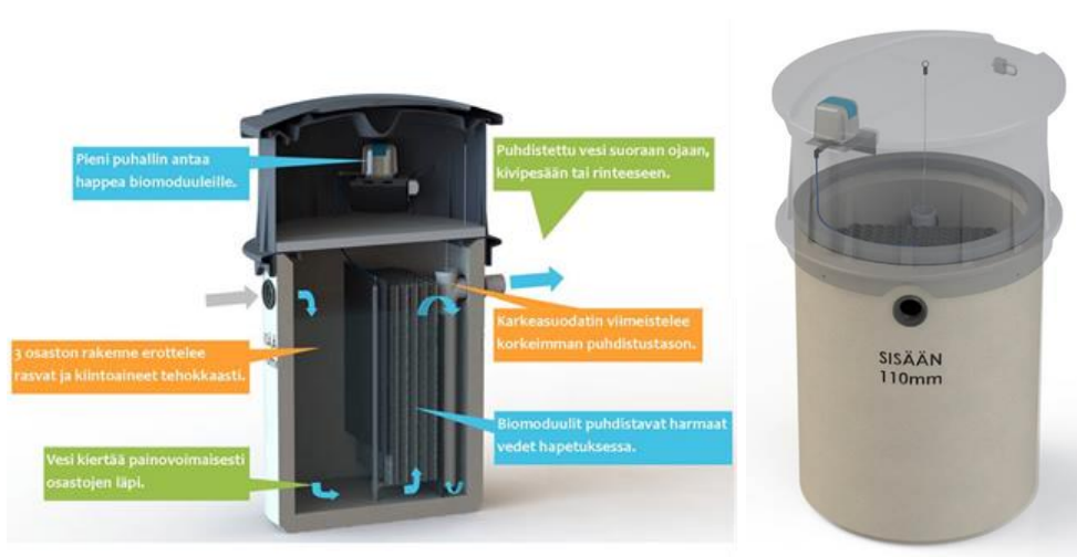
Biopuhdistaja 3- harmaavesipuhdistajan läpileikkaus ja kuva
